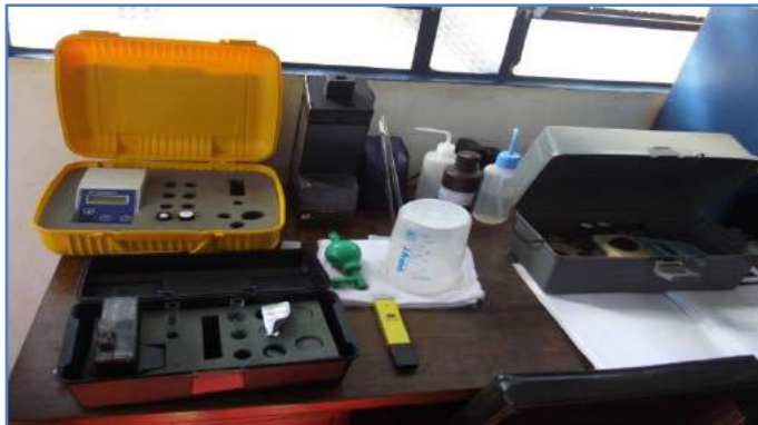
Imagem 37: Equipamentos para análise de água.
